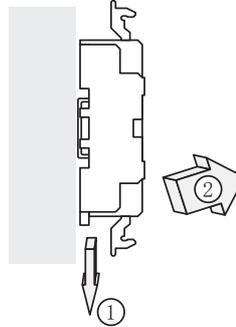
ソケット下部のレールホルダの溝にマイナス・ドライバ等を挿し込み、それを下方に押しながらソケットの下部を手前に引きます。
