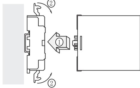
本体の上下方向を確認して、ピンをまっすぐ挿し込んだ後、ソケットの上下についているストッパ・フックを本体ケース上の孔にかけてロックします。
