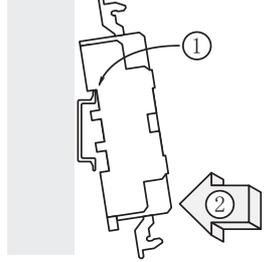
ソケット基盤についているレールホルダ（黄色の部分）を下にして、その反対方向にあるツメをレールに引っ掛けてからソケットを図のように嵌め込み、レールホルダをかけて固定します。
