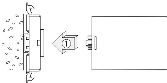
请确认主体的上下方向，将各输入输出与对应端子台的位置对齐，将主体笔直插入
