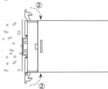
请将主体固定用的限位器配合主体的孔，进行锁定
