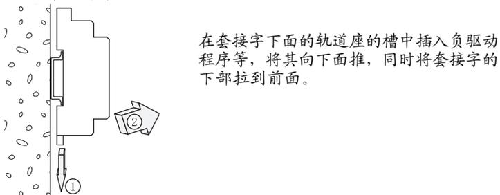
主体的安装拆卸
