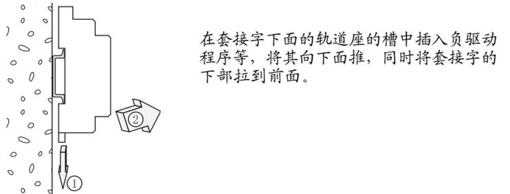
主体的安装拆卸
